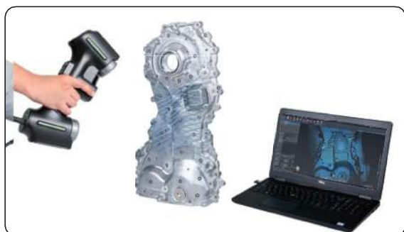
Hitro skeniranje : 26 prečnih modrih laserskih žarkov (računalnik je dodatna oprema)
